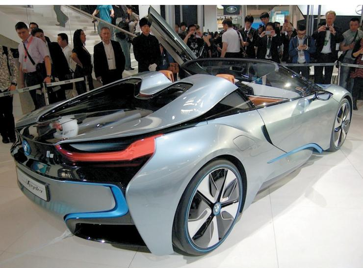
Прототип имеет весьма солидные размеры – 4,48 м в длину и 1,92 м в ширину – и снаряжённую массу 1630 кг, которая поровну распределяется по осям, что делает автомобиль более устойчивым в сложных дорожных условиях.
