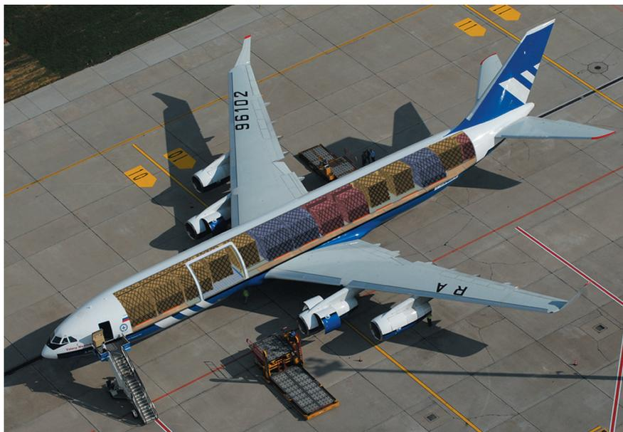
Универсальная напольная система, с использованием стандартных погрузочных устройств и наземного оборудования, позволяет производить погрузку поддонов и контейнеров на верхнюю палубу через грузовую дверь 4850 x 2875 мм по левому борту и на нижнюю палубу через грузовые двери 2690 x 1730 мм и 2690 x 1840 мм по правому борту.
