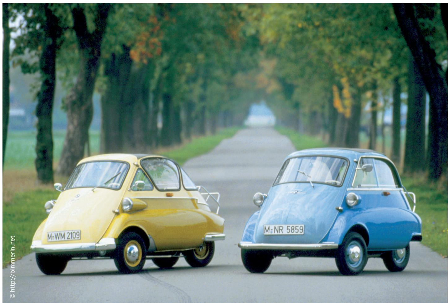
ным двигателем. На первую германскую модификацию этой машины – BMW Isetta 250, выпускавшуюся с 1955 года, – ставили одноцилиндровый 245-кубовый мотор с воздушным охлаждением, выдававший 12 лошадиных сил.
