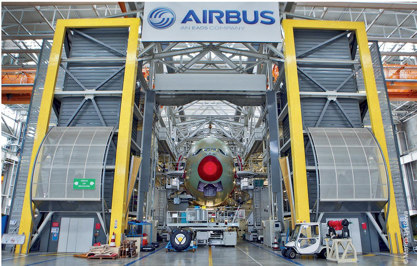
тов – это огромная работа, поэтому для оптимизации этого процесса разные части самолётов производят на разных заводах: к примеру, носовые и задние части фюзеляжа изготавливаются в Германии, а крылья – в Великобритании. Во Франции же производят самолётные двигатели, кабину и центральную часть фюзеляжа, а также собирают воедино весь самолёт.
