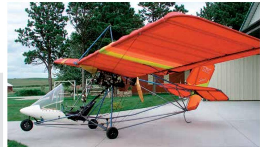
Этому условию соответствует Quicksilver MX Sport – самолёт с открытым кокпитом. Он идеально подходит для развлекательных и обучающих полётов. Самолёт оснащён крыльями со сложным профилем (две плоскости), двигателем мощностью в 40–50 лошадиных сил и управляемым носовым колесом. Quicksilver MX Sport обладает отличными характеристиками при взлёте и
