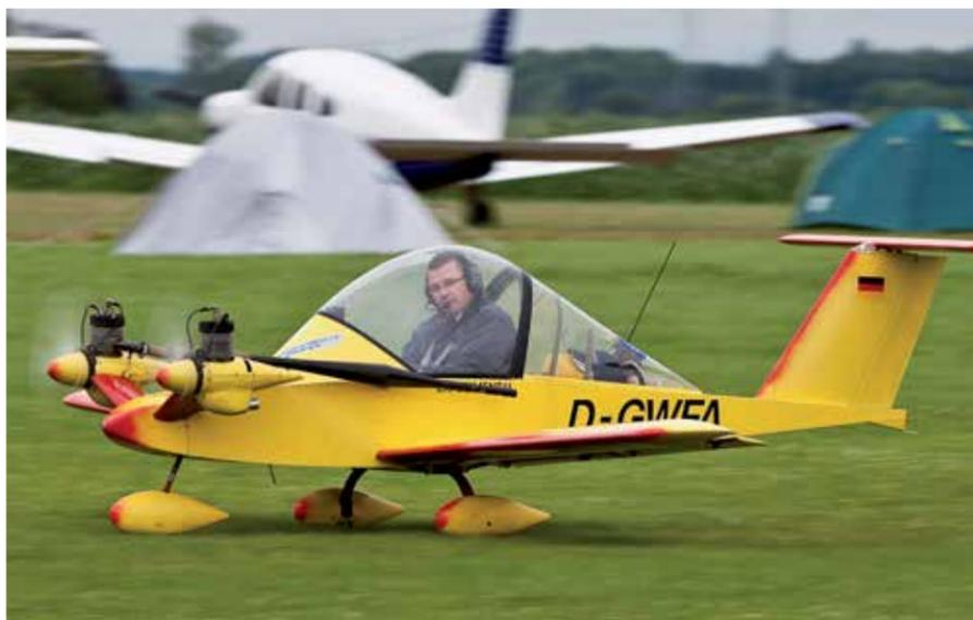
ление и интерес многих любителей авиации. На первый взгляд он выглядел необычно. Простая угловатая форма фюзеляжа, непривычно большой «обтекаемый» фонарь кабины, а также два двигателя, установленные на пилонах в носовой части фюзеляжа – всё это смотрелось странно и заманчиво. После многочисленных испытаний, неудач и революционных изменений самолёт был поставлен на поток – в 1983 году Коломбан запустил производство КИТ-комплектов Cri-Cri для самостоятельной сборки любителями в домашних условиях.
