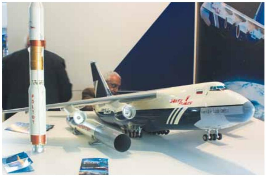
скую траекторию. В это время (примерно 6 – 10 секунд) самолёт будет находиться в состоянии, близком к режиму невесомости. Соответственно, в результате незначительной перегрузки, вес ракеты возрастёт в 2 – 2,5 раза. И именно в этот момент произойдёт выброс ракеты с применением пневматической системы выталкивания – процесс должен занять не больше 3 секунд.
